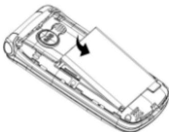
Установите заднюю крышку на место. При установке раздастся щелчок.
