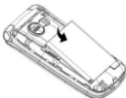
Vuelva a colocar la cubierta. Oirá un chasquido cuando esté montado.
