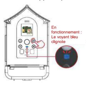
Sélectionnez l'icône de fonction « » et cliquez sur le bouton pour passer en mode Photo. La mangeoire éteindra automatiquement l'écran lorsque des oiseaux ou des objets entrent dans la zone de détection PIR, et le voyant clignotera en bleu. L'appareil photo prendra automatiquement 3/5/10 photos sans opération manuelle.
